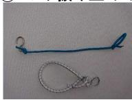
抜けどめをつける目的は完沈してもマストが抜けないようにすることです。 ※完沈してマストが抜けかかっている艇を起こすときにマスト底部が マストホールの内壁を壊す恐れがありますので、艇が完沈しても マストが最大でも5cm程度で抜けかかったところでとまるよう 調整して下さい。
