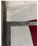
②ILCA7(スタンダード)はミドルバテンポケットのところにあるパネルのシームの下端から 400mm±12mmを確認、ポート側はスターボードの下端から400mm±12mmを確認します。 ILCA6(ラジアル)はミドルバテンポケットの下端から400mm±12mmを確認します。 ILCA4(4.7)はミドルバテンポケットの下端から270mm±12mmを確認します。
